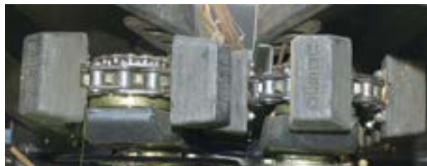
Sercem hедера Drago Gold są wykonane z twardej gumy zęby chwytnie. Na każdym z łańcuchów jest ich szesnaście, a w całej 16-rzędowej przystawce ponad pół tysiąca!
