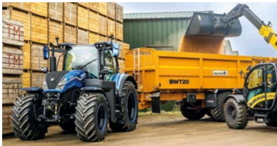
New Holland T7 Methane Power LNG o mocy 270 KM rozwija tę samą moc i ten sam moment obrotowy jak jego odpowiednik T7.270 z napędem na diesel.
