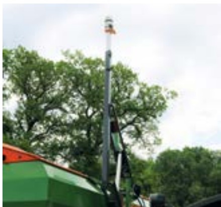
Czujnik wiatru zamontowany jest na wysięgniku, aby nie mierzył turbulencji generowanych przez traktor.
