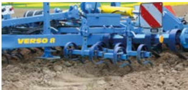
Pierwszym elementem roboczym agregatu Verso są spulchniacze śladów kół ciągnika.
