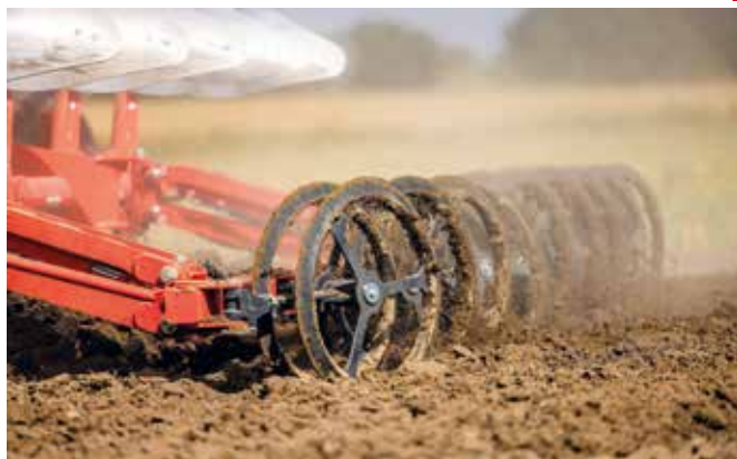
Zadaniem wału Duoliner jest ugniatanie gleby pierścieniami, które montowane są po dwa na jednym ramieniu. Oddalone są od siebie o 15 cm, a ich średnica wynosi 60 cm.
