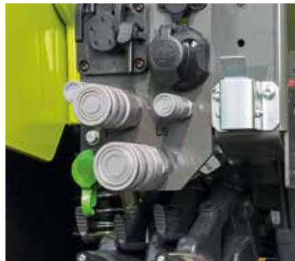
Panel Power Beyond w wersji z trzema (z lewej) i czterema przyłączami.
