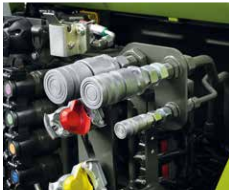
Panel Power Beyond w wersji z trzema (z lewej) i czterema przyłączami.
