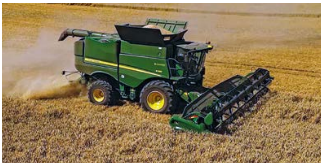
John Deere S780 Konrada Pietrzaka z demonstracyjnym taśmowym zespołem żniwnym RD35F podczas zbioru pszenicy ozimej o średnim plonie 9 t/ha rozpędzał się do 5-6 km/h.
