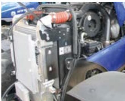
Nowa najsilniejsza 300-konna jednostka napędowa serii T7 LWB mieści się bez problemu pod standardową wąską maską. Jedynie w obrębie większej, nie stosowanej wcześniej, turbosprężarki eVGT trzeba było zastosować specjalne wybrzuszenie prawej dolnej osłony (strzałka).
