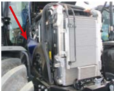
Nowa najsilniejsza 300-konna jednostka napędowa serii T7 LWB mieści się bez problemu pod standardową wąską maską. Jedynie w obrębie większej, nie stosowanej wcześniej, turbosprężarki eVGT trzeba było zastosować specjalne wybrzuszenie prawej dolnej osłony (strzałka).
