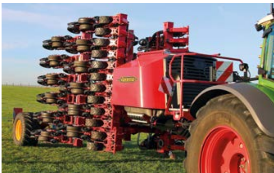
Zbudowany przed firmę Väderstad siewnik Proceed jest maszyną przyczepianą o szerokości roboczej wynoszącej 6 m i transportowej 3 m.
