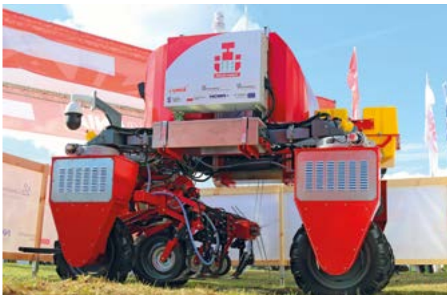
Inteligentny robot ma pracować na polu kukurydzy od momentu jej siewu do osiągnięcia wysokości ok. 1 metra. Jego zadaniem oprócz wysiewu nasion ma być pielenie, nawożenie mineralne i opryskiwanie plantacji. Służący do tego celu osprzęt będzie wymienny.
