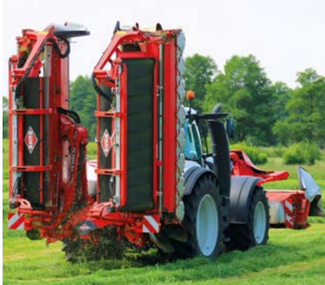
Środek ciężkości tylnych kosiarek znajduje się w odległości 50 cm od ramion TUZ.
