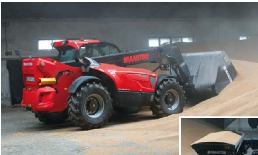
Kupiona do gospodarstwa w miejscowości Nowy Staw ładowarka Manitou MLT 961-140 V+L jest wykorzystywana głównie do przeładunku i załadunku zbóż. Maszyna jest skompletowana z łyżką o dużej pojemności – 4 m 3 .
