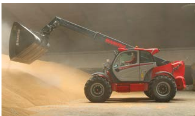
Maszyna pracuje w magazynie płaskim. Podczas żniw jej zadaniem jest szybkie podgarnianie i stertowanie zboża. Ułatwia to długi wysięgnik teleskopowy.
