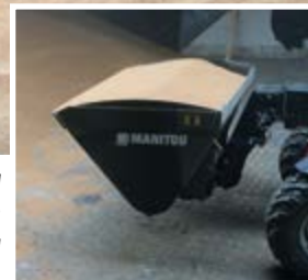
Kupiona do gospodarstwa w miejscowości Nowy Staw ładowarka Manitou MLT 961-140 V+L jest wykorzystywana głównie do przeładunku i załadunku zbóż. Maszyna jest skompletowana z łyżką o dużej pojemności – 4 m 3 .
