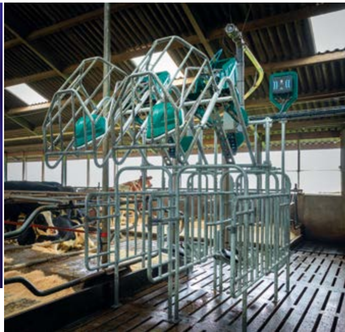
CowToilet holenderskiej firmy Hanskamp to połączenie stacji żywienia z innowacyjnym urządzeniem do odbierania i chwilowego magazynowania moczu od krowy.
