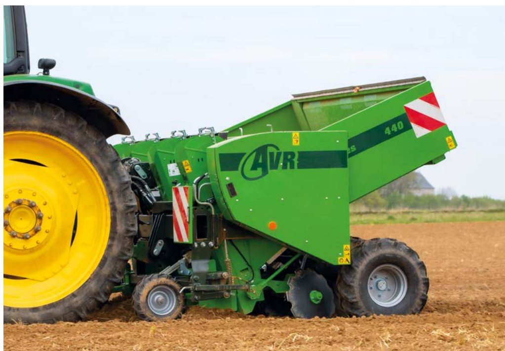
W sadzarce AVR Ceres 440 wzrosła o blisko 14% średnica talerzy obsypujących luźną glebę odłożone bulwy.
