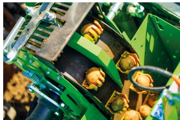
W wariantcie hydraulicznym nowej maszyny każda taśma wysadzająca ma niezależny napęd.
