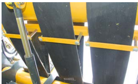
Specjalne ograniczniki dbają o właściwe utrzymanie pasów stołu względem siebie.
