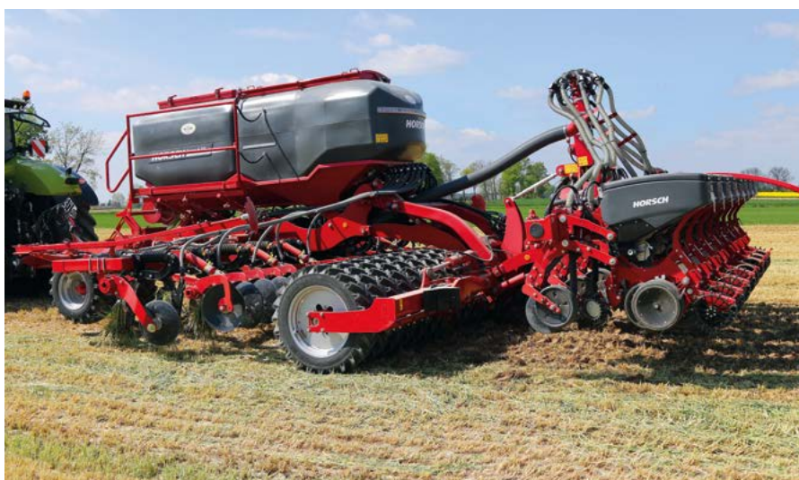
Mieliśmy okazję obserwować pierwszy w Polsce siewnik Horsch Focus 6TD nowej generacji, z tylnym trzypunktowym hydraulicznym układem zawieszania.
