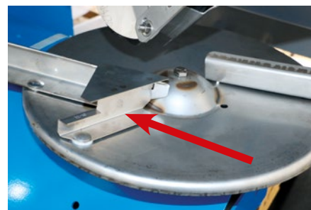
Najprostsze maszyny mają realizowany siew graniczny poprzez łopatkę Ecobord.
