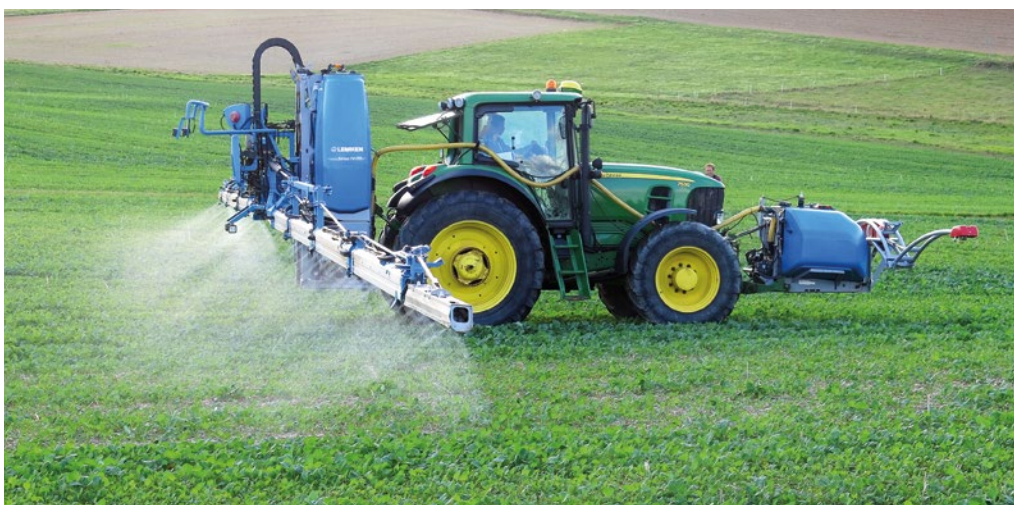
Isaria Fritzmeiera to aktywny skaner chlorofilu. Jego pełna nazwa producenta to Isaria Pro Active.
