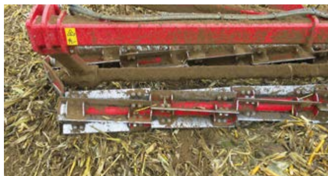
Wał podwójny Cultro 12 TC ma dwa wały o średnicy 30 cm, wyposażone w długie ostrza, osadzone skośnie.
