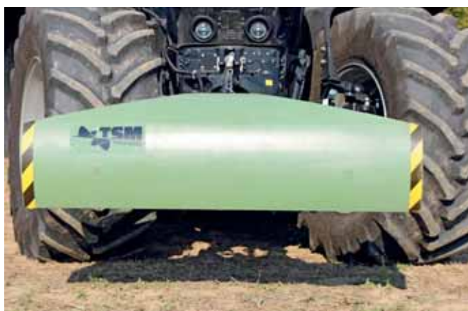
Pod obudową skanera TopSoil Mapper, który można pomylić z eleganckim obciążnikiem, mieszczą się cztery czujniki i jeden nadajnik.
