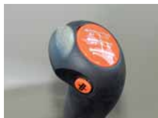
Za wybór jednego z 12 przetożeń odpowiadają dwie dźwignie. Na jednej z nich znajdziemy przycisk wysprężania głównej skrzyni o nazwie Easy Shift.
