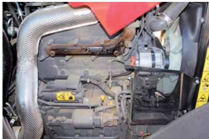
Sercem kandydata do tytułu Tractor of the Year 2019 w kategorii ciągników wielozadaniowych jest czterocylindrowy silnik fińskiej marki AGCO Power o pojemności 4,4 l.
