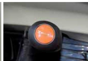
Za wybór jednego z 12 przetożeń odpowiadają dwie dźwignie. Na jednej z nich znajdziemy przycisk wysprężania głównej skrzyni o nazwie Easy Shift.
