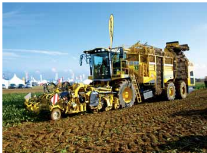
Teraz w kombajnie Ropa Tiger 6 są do wyboru dwa nowe silniki Volvo o bardzo dużej mocy 768 i 700 KM.
