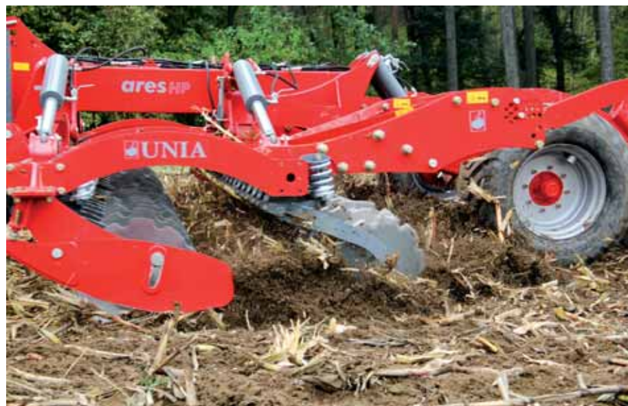
Do testu otrzymaliśmy agregat Ares HP TX 660 Agressive. Jego elementami roboczymi są talerze uzębione o średnicy 660 mm i grubości 6 mm.
