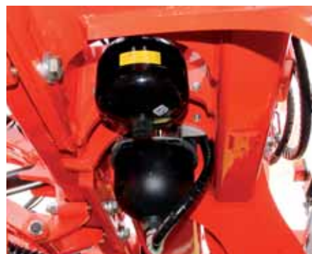
Jeden ze schowanych pod ramą akumulatorów hydraulicznych współpracuje z mechanizmem równoległobocznym wszystkich sekcji.
