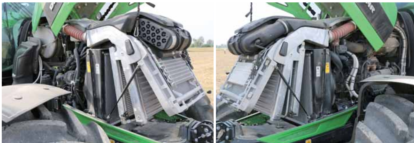
Deutz-Fahr 6215 RCshift ma silnik sześciocylindrowy o mocy znamionowej 214 KM. Norma emisji spalin Euro IV osiągnana jest m.in. dzięki filtrowi DPF i systemowi SCR.
