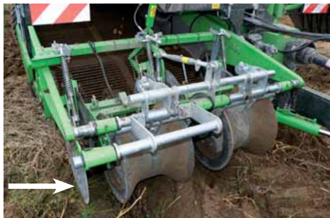
Agregat kopiący uzbrojony jest w rolki z tworzywa sztucznego oraz pięć krojów tarczowych. Ten piąty (strzałka) to wyposażenie opcjonalne.
