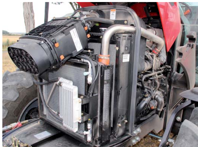
Pod maską najnowszego flagowego Týma kryje się 105-konny czterocylindrowy koreański motor marki Doosan.
