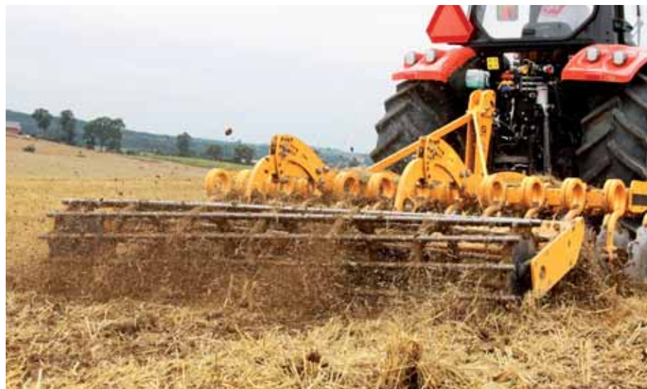
Do testu otrzymaliśmy agregat z wałem rurowym o średnicy 450 mm. To najprostszy z oferowanych przez firmę Agristem wałów.
