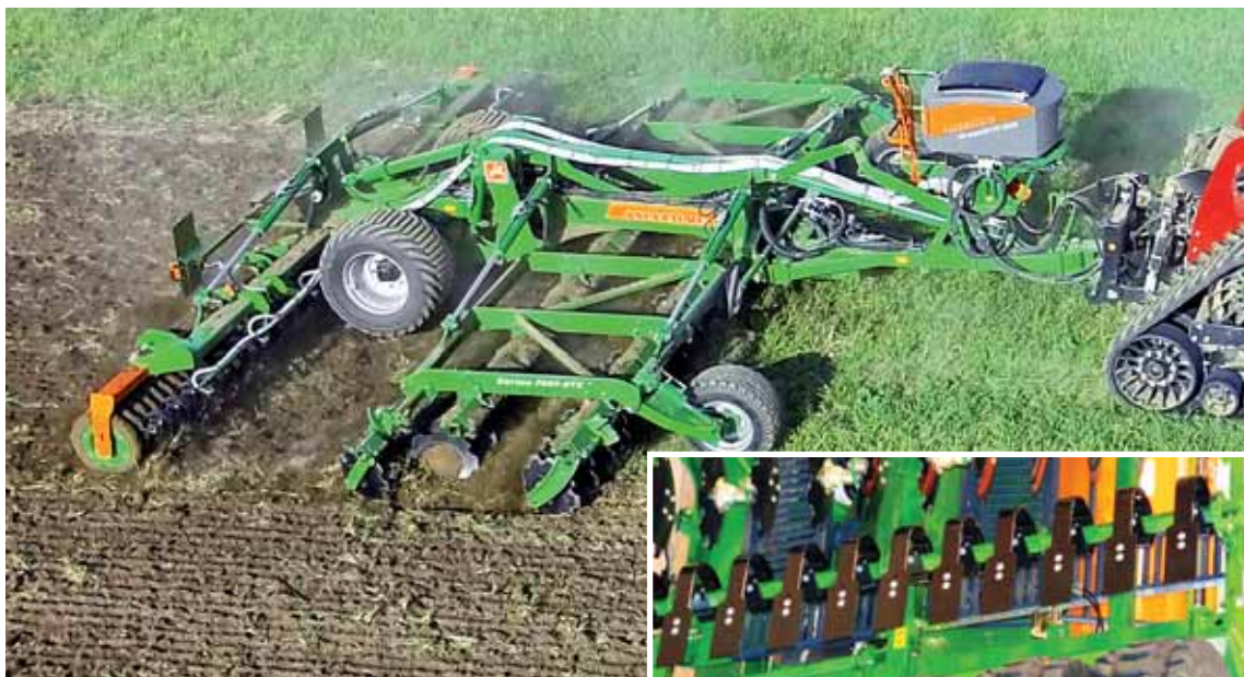
Certos TX jest nową kompaktową broną talerzową Amazone. Charakteryzuje się dużymi karbowanymi talerzami o średnicy 660 mm oraz możliwością zamontowania dodatkowego wyposażenia w postaci brony/włóki Crushboard.
