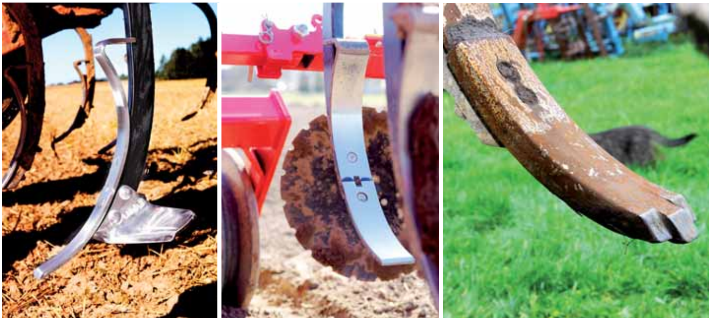
Dla Cultusa przeznaczone są proste nakładki o szerokości 50 i 80 mm, a także „długodystansowe” utwardzone nakładki Marathon
