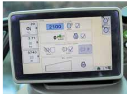
CommandCenter trzeciej generacji to komputer stacjonarny. Poza funkcjami monitora ciągnika obsługuje aplikacje AutoTrac i Section Control. Ma również funkcję menu niedźwiedzia dostępną.
