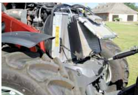
Pod maską N123 pracuje 4,4-litrowy, turbodoładowany motor AGCO Power, czyli dawne Sisu.
