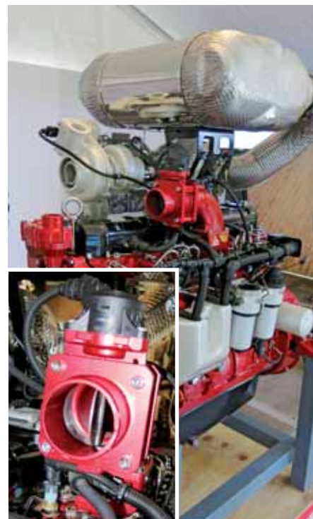
Motory AGCO Power 66 AWF i 74 AWF, które znajdują się pod maskami ciągników Valtra serii T4, spełniają normę czystości spalin Euro IV. Pomimo to są proste dzięki zastosowaniu układu SCR oraz zwykłej turbiny z zaworem regulującym ciśnienie w układzie dolotowym.
