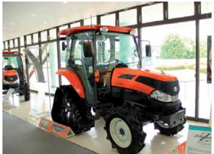
Na polach ryżowych sprawdzają się gąsienice zamiast kół, więc na życzenie klienta może je mieć ciągnik marki Kubota.
