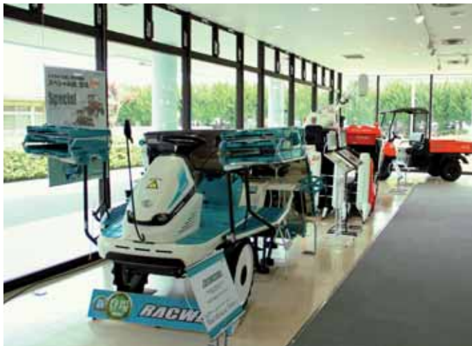
Jaką maszynę widać na pierwszym planie? Odpowiadamy – samojezdna sadzarka do ryżu.
