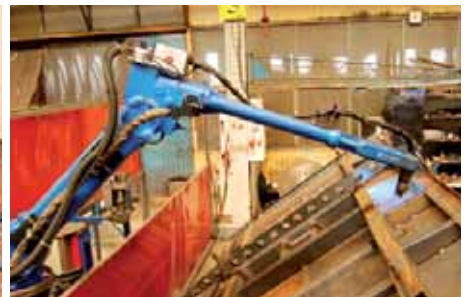
Części metalowe wypalane są plazmą lub laserem 3D, a burty przyczep spawa robot. Taka automatyzacja pozwala zachować powtarzalność wykonywanych elementów.
