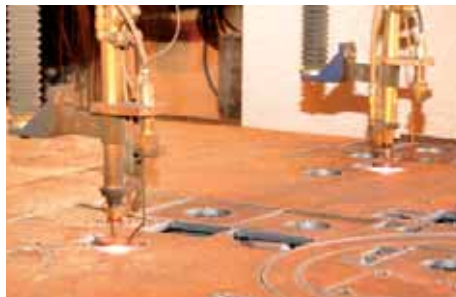
Części metalowe wypalane są plazmą lub laserem 3D, a burty przyczep spawa robot. Taka automatyzacja pozwala zachować powtarzalność wykonywanych elementów.
