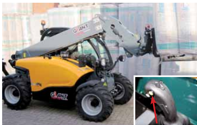
W modelach T133H i T144H hiszpańskiej marki AUSA osiowa pompa wielotłoczkowa zasila olejem trzy szeregowo ze sobą połączone promieniowe silniki wielotłoczkowe. Jeden z nich napędza przedni most, zaś dwa pozostałe są zamocowane w tylnych kołach.
