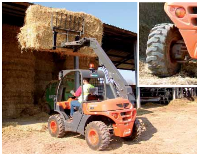
W modelach T133H i T144H hiszpańskiej marki AUSA osiowa pompa wielotłoczkowa zasila olejem trzy szeregowo ze sobą połączone promieniowe silniki wielotłoczkowe. Jeden z nich napędza przedni most, zaś dwa pozostałe są zamocowane w tylnych kołach.
