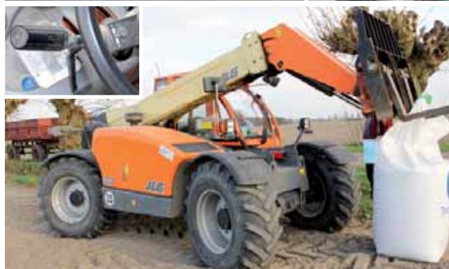
Największe grono ładowarek z hydrostatycznym napędem stanowią maszyny z dwoma hydraulicznymi przełożeniami. Zakresy zmieniane są elektrohydraulicznie, np. przyciskami na dźwistku bądź poprzez obrót manetki dźwigni rewersu przy kierownicy.
