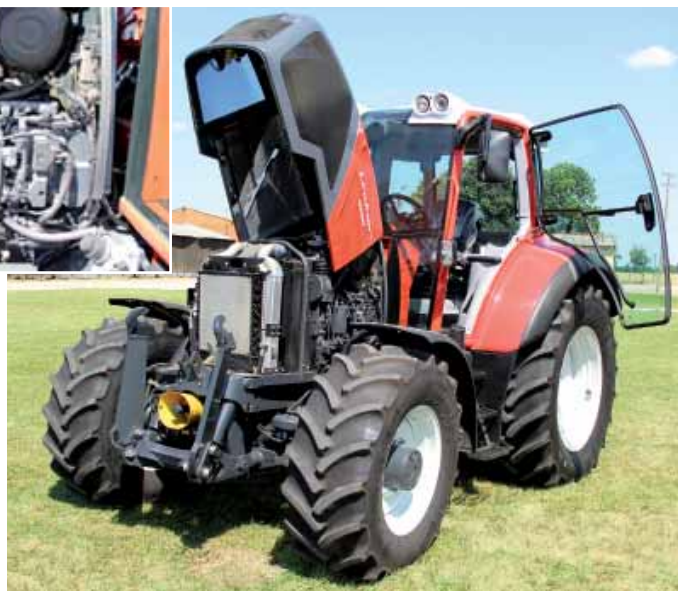
Pod maską austriackiego traktora pracuje czterocylindrowy Perkins o pojemności 4,4 l, wyposażony w układ wtrysku Common Rail.
