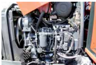
Pod maską austriackiego traktora pracuje czterocylindrowy Perkins o pojemności 4,4 l, wyposażony w układ wtrysku Common Rail.
