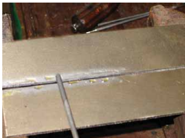
Trawienie łączonych krawędzi usuwa z nich trudno topliwe tlenki i tłuszcz.
