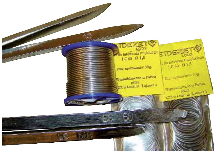
Oznaczenie na szpulkach z drutem lub prętach lutowniczych opisuje procentową zawartość cyny w stopie.
