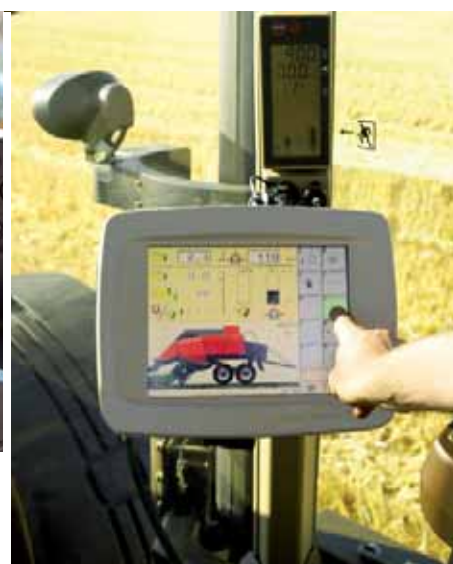
Isobus miał umożliwić stosowanie jednego terminalu do sterowania różnymi maszynami, zamiast używania kilku – do każdej maszyny osobnego.
