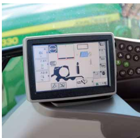
Dzięki technologii Isobus możemy sterować kilkoma różnymi maszynami, różnych producentów, za pomocą jednego terminalu.
