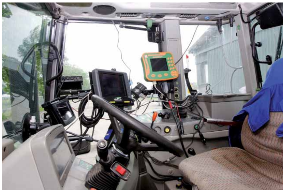
Isobus miał umożliwić stosowanie jednego terminalu do sterowania różnymi maszynami, zamiast używania kilku – do każdej maszyny osobnego.
