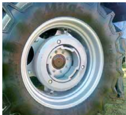
Firma Lima to odlewnia żeliwa, która posiada w ofercie elementy balastowe, zarówno zakładane na przód ciągnika (walizkowe), jak i na TUZ oraz montowane na obręczach kół.
