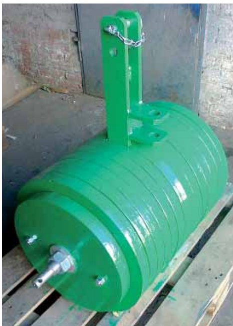
Firma Lima to odlewnia żeliwa, która posiada w ofercie elementy balastowe, zarówno zakładane na przód ciągnika (walizkowe), jak i na TUZ oraz montowane na obręczach kół.
