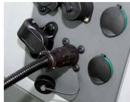
Jeśli traktor nie ma własnego wyświetlacza obsługującego Isobus, to musimy wyświetlacz współpracujący z tą szyną danych podłączyć także do gniazda w kabinie.
