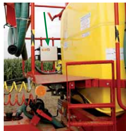
Isobus zaczyna się od narzędzia, które musi być wyposażone w odpowiedni sterownik i kabel umożliwiający połączenie z ciągnikiem.
