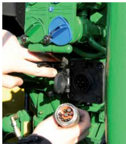
Do gniazda znajdującego się na ciągniku podłączamy kabel z wtyczką. To wystarczy, aby móc uaktywnić szynę danych.
