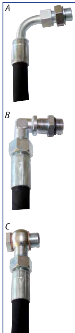
Trzy sposoby przykręcenia przewodu hydraulicznego pod kątem 90° do elementu hydraulicznego za pomocą: kolana zwykłego (A), kolana z kątem prostym i długim gwintem (B) i przyłącza oczkowego (C).
