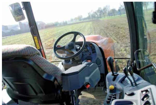
Kabina nowej Kuboty jest bardzo przestronna, większa i szersza od kabiny poprzedniego modelu. Bardzo dobra widoczność we wszystkich kierunkach to zasługa oparcia jej na czterech słupkach.
