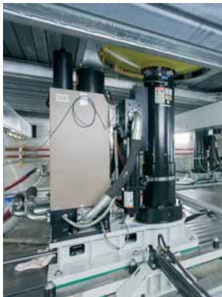
Każdy z siłowników zamontowany jest na potężnych podstawach i dźwiga 25 t.
