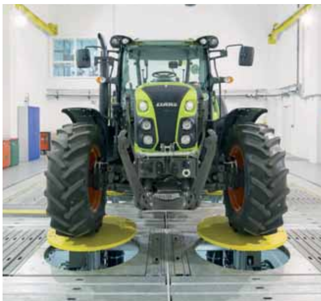
Na stanowisku do oceny wytrzymałości podzespołów na wibracje Claas testuje swoje ciągniki, kombajny, siewczarnie, prasy i ładowarki.
