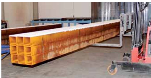
Rury po odebraniu od dostawcy zostały celowo wystawione pod przysłowiową chmurkę w celu skorodowania. To prosty sposób na pozbycie się pozostałości po natłuszczeniu.
